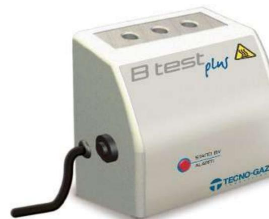
**El incubador biológico** es un producto desarrollado para la incubación de indicadores biológicos a 57 °C. El incubador está compuesto por un armazón, una carcasa de ABS, un bloque térmico de aluminio dotado de 3 alojamientos para las probetas/indicadores biológicos y una tarjeta electrónica para la gestión automática de la temperatura del bloque térmico. Dispone de fuente de alimentación independiente 230VAC.
