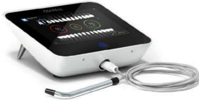
**Sistema rápido**, no invasivo y fácil de usar para determinar la estabilidad del implante y evaluar el proceso de osteointegración.
