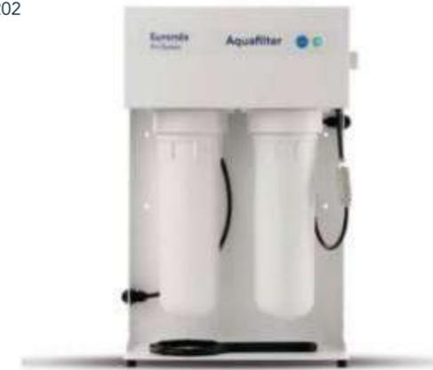
**Dispositivo** que produce agua desionizada para el autoclave, de conformidad con la norma EN13060 (<15 µS/cm). Se puede conectar a un único autoclave. Aquafilter desioniza una media de 1 litro de agua por minuto. Se puede instalar en la superficie de trabajo, dentro de un armario o empotrado.
