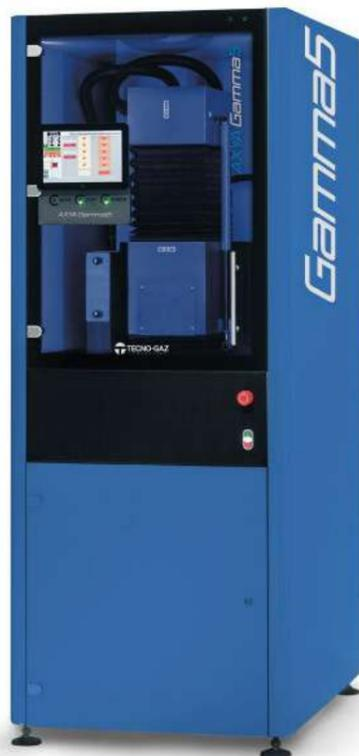
**Fresadora universal** para laboratorio dental. Interpolación continua de cinco ejes para fresado en seco y en húmedo.
