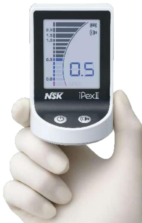
**Localizador de ápices avanzado** con controlador Smartlogic de nueva generación, que elimina prácticamente todas las interferencias en la señal del conducto radicular para detectar la ubicación exacta del ápice.
